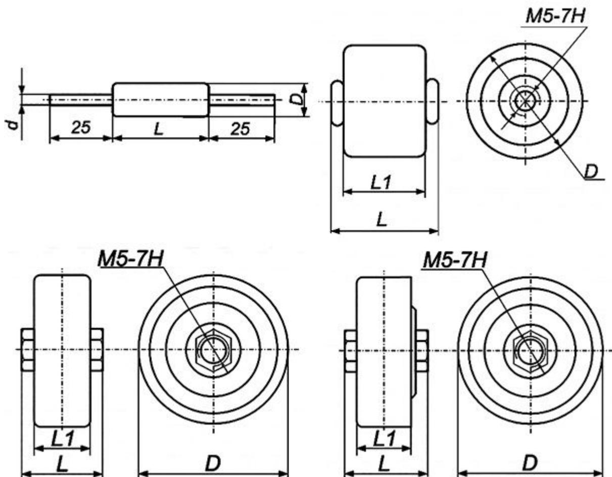
Габаритные размеры и масса конденсаторов КВИ-1
