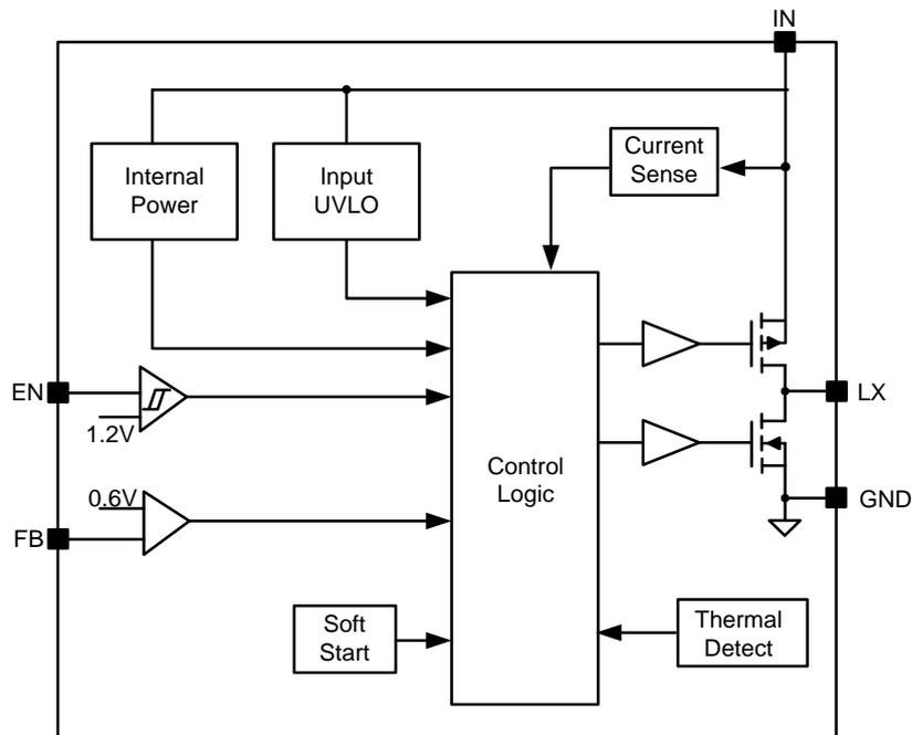
**Figure3. Block Diagram**
