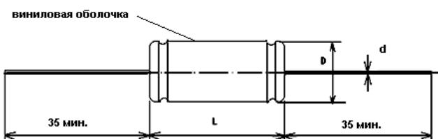
**Габаритные размеры корпуса, максимальный импульсный ток при 105°C 120Гц.**
