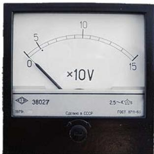
Вольтметр Э8027 предназначен для измерения напряжения в цепях переменного тока на передвижных и стационарных объектах.
