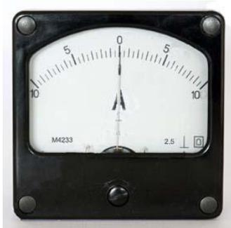
Амперметр М4233 предназначен для измерения силы тока в электрических цепях постоянного тока. Вибропрочные, тряскопрочные. Герметичные.
